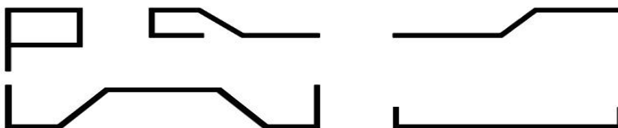
Рис. 5 Формы изгиба арматуры
