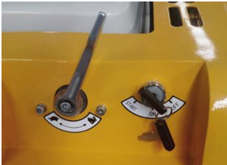
Ручка газа и замок зажигания
