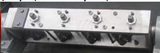
Рис.3 Опоры направляющей рамы, ролики, подшипники
