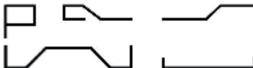
Рис. 5 Формы изгиба арматуры
