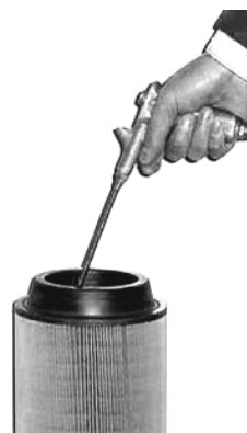
Рис. 6.3 Очистка фильтрующего элемента воздушного фильтра
