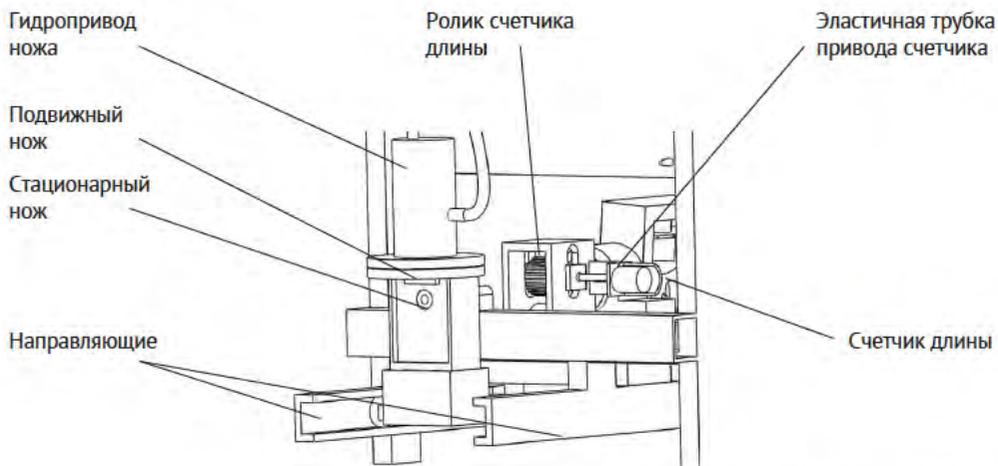
Рис. 3 Система резки
